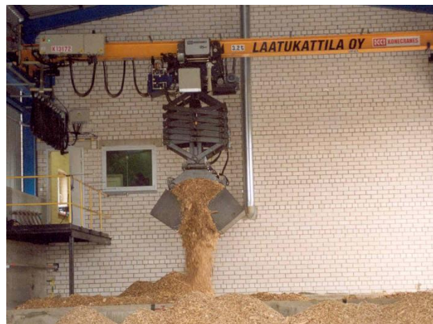
Suuria polttoainevarastoja (1000 – 3000 m 3 ) varten Laatukattila on kehittänyt ja patentoinut ohjelmoidun polttoainekahmarin.
